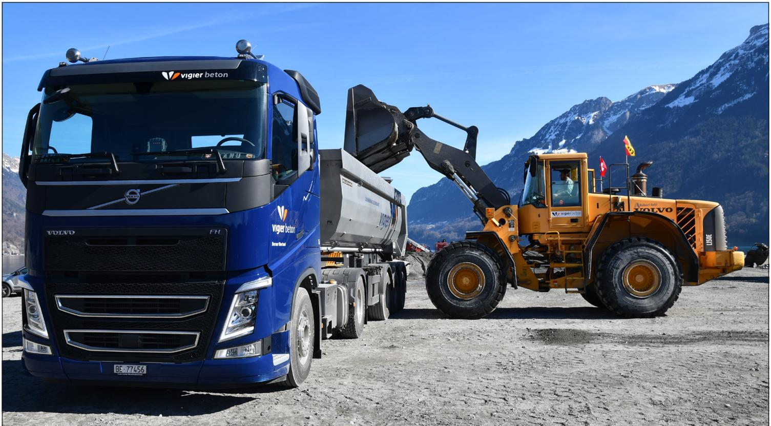
**Rohmaterial für das Kieswerk:** Der neue Kippschlepper wird beladen, das Fahrzeug verfügt über 25 Tonnen Nutzlast.
